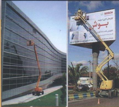
بالابر مفصلی دیزلی ارتفاع دسترسی: ۱۸ متر دسترسی افقی: ۱۰,۶ متر ۲۶ متر ۱۶ متر
