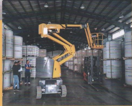
بالابر مفصلی برقی ارتفاع دسترسی: ۱۵ متر دسترسی افقی: ۹ متر
