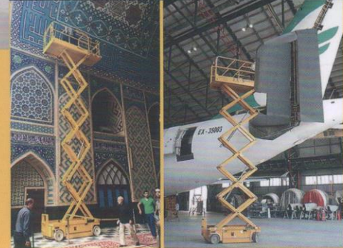
بالابر آکاردئونی برقی ارتفاع دسترسی: ۱۲ متر طول سبده: ۳,۲۰ متر
