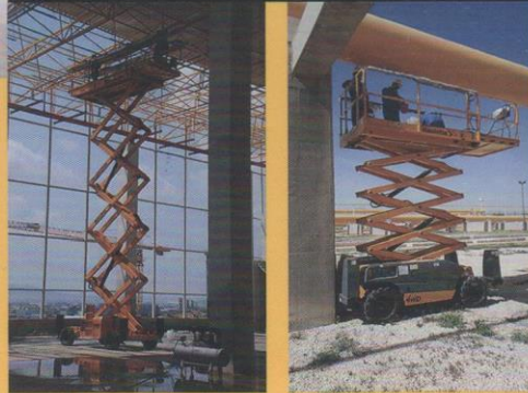
بالابر آکاردئونی دیزلی ارتفاع دسترسی: ۱۲ متر طول سبده: ۳,۷۰ متر ۱۸ متر ۶ متر
